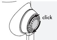
Lösen Sie den Druck vom Stift und drehen Sie diesen weiter im Uhrzeigersinn bis es „klickt“.
