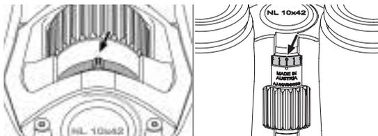
Achten Sie bei gleicher Sehkraft beider Augen darauf, dass sich der Dioptrienausgleich in der Nullstellung befindet. Die Nase des Stellrings rastet spürbar in der Nullstellung ein und die Skala auf der Rückseite des Gerätes stimmt mit dem Index überein.
