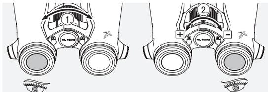
Blicken Sie mit dem linken Auge durch das linke Okular und stellen Sie mit dem Fokussiertrieb die Bildschärfe eines ausgewählten Objektes ein.
