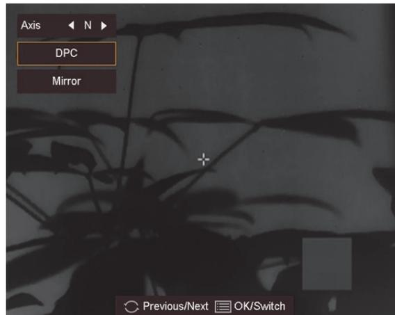
**Abbildung 3-4 Defekte Pixel korrigieren**
