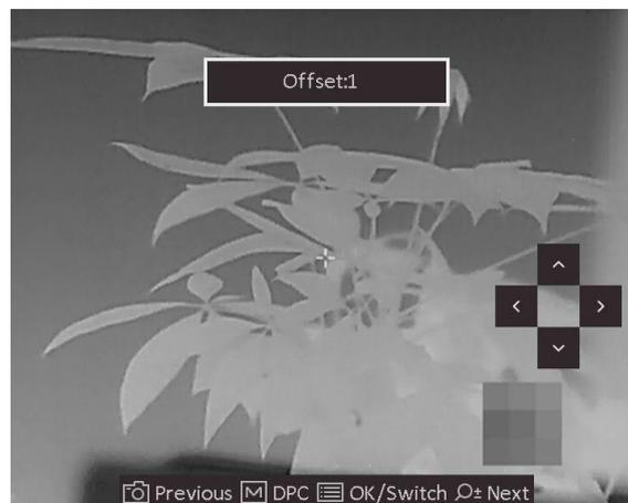
Abbildung 3-5 Defekte Pixel korrigieren
