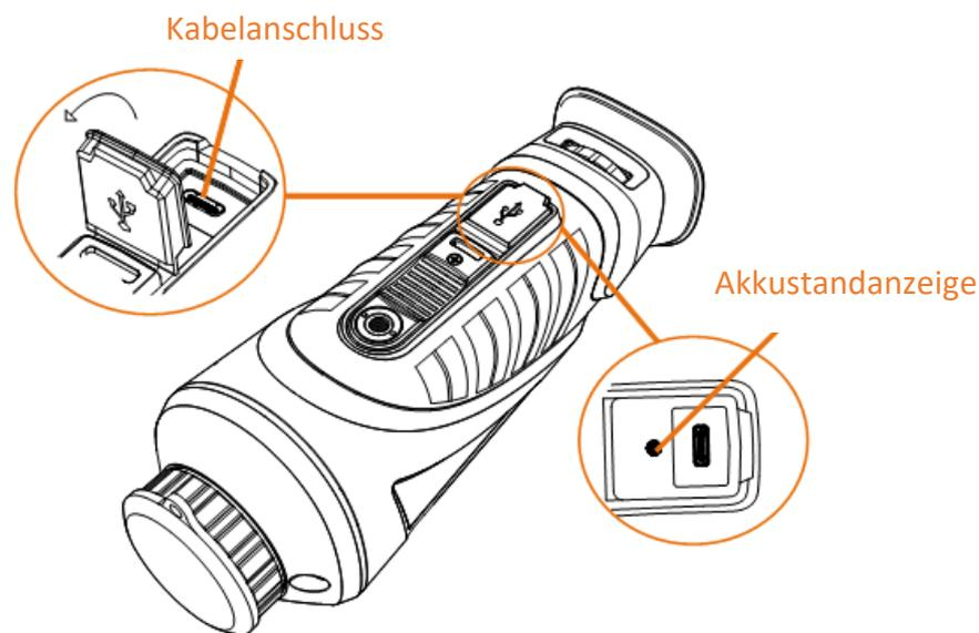
Abbildung 2-1 Kabelanschluss
