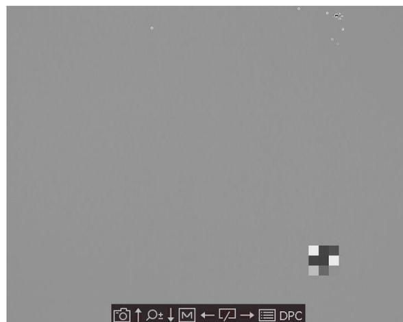
Abbildung 3-3 Defekte Pixel korrigieren
